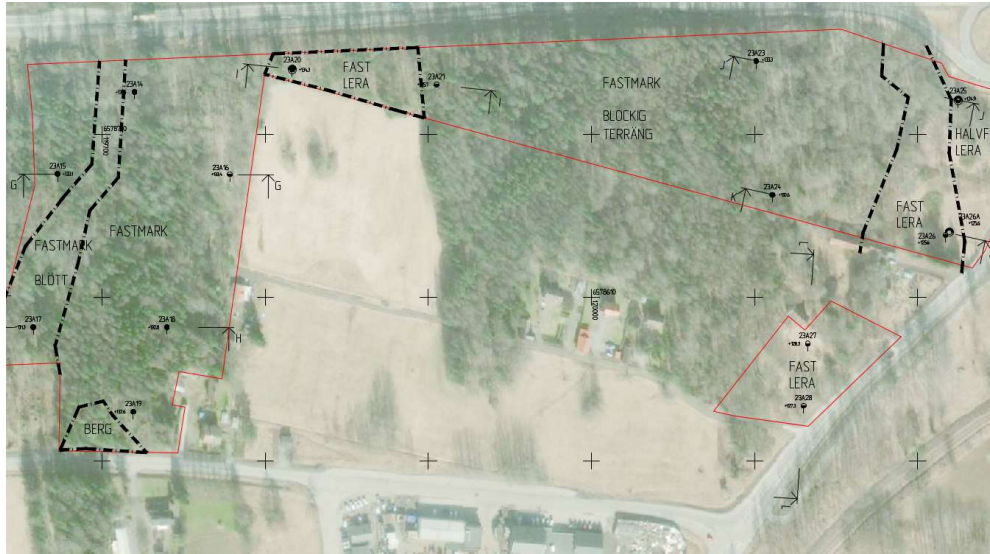
Figur 8 Översiktlig kartering utifrån utförda sonderingar, jordartskarta, topografi och fältbesök.
