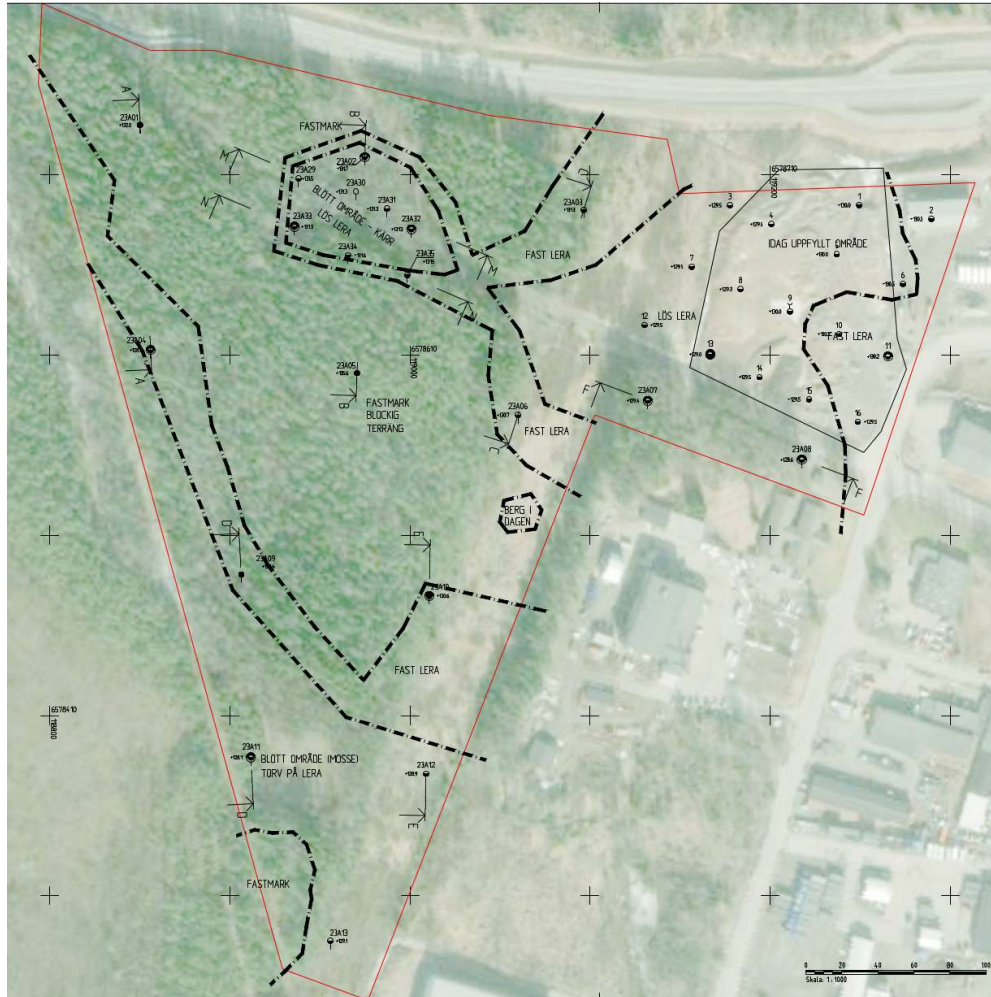
Figur 3 Översiktlig kartering utifrån utförda sonderingar, jordartskarta, topografi och fältbesök.
