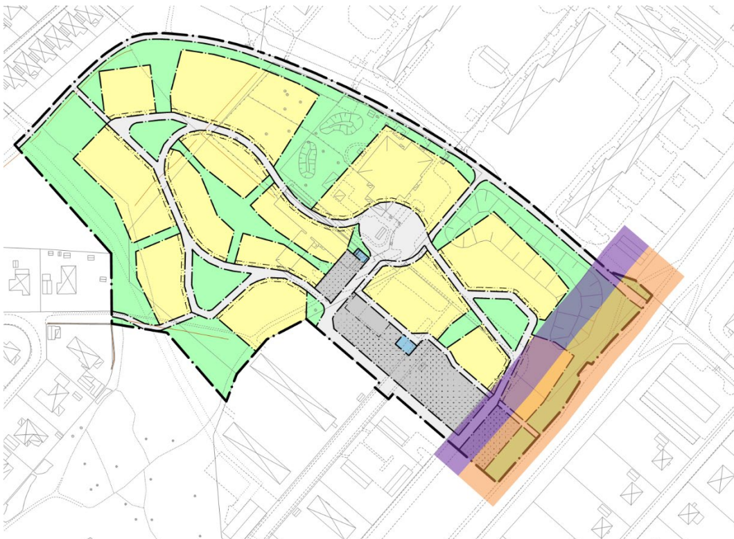
Figur 30: Resultatet från bullerberäkningarna från Drottningvägens mitt visar inom vilket område 50 dBA ekvivalent ljudnivå (lila yta) samt 70 dBA ekvivalent ljudnivå (orange yta) överskrids år 2045.
