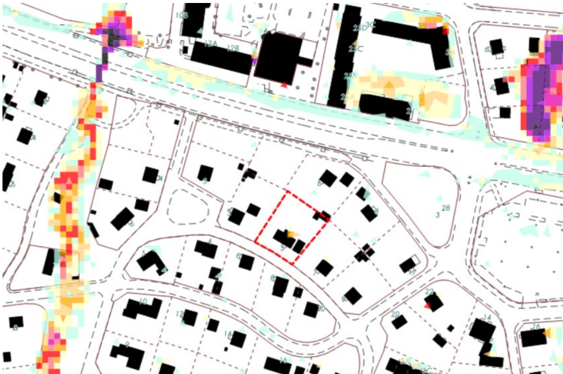
Figur 9 Bilden visar flödena för dagvatten vid ett eventuellt 100-årsregn.
