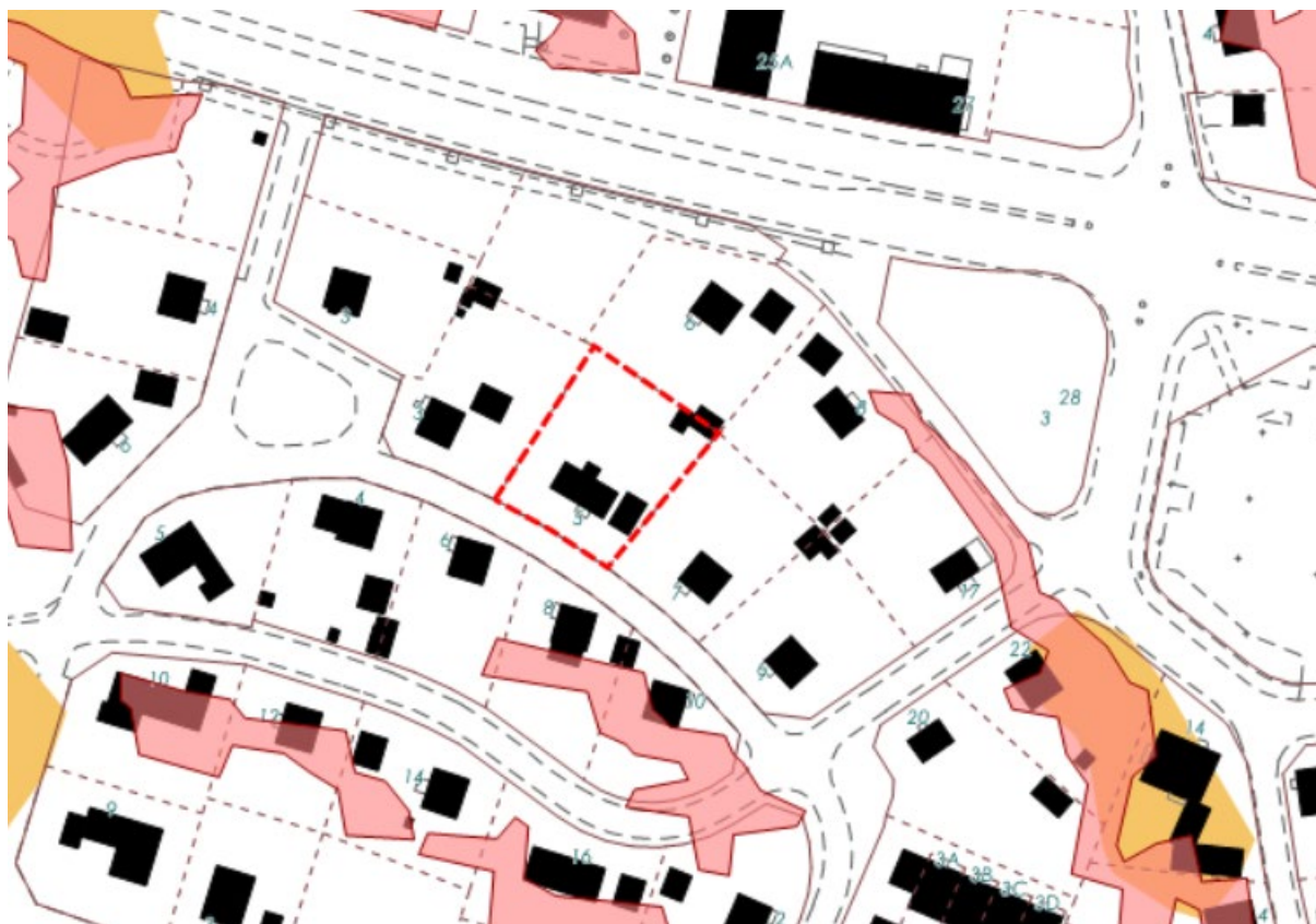
Figur 8 Rött fält visar områden inom jordarten lera/silt som lutar minst 10% och kan ha förutsättningar för skred (LST). Orange fält visar områden med förutsättningar för jordskred i finkornig jordart (SGI).
