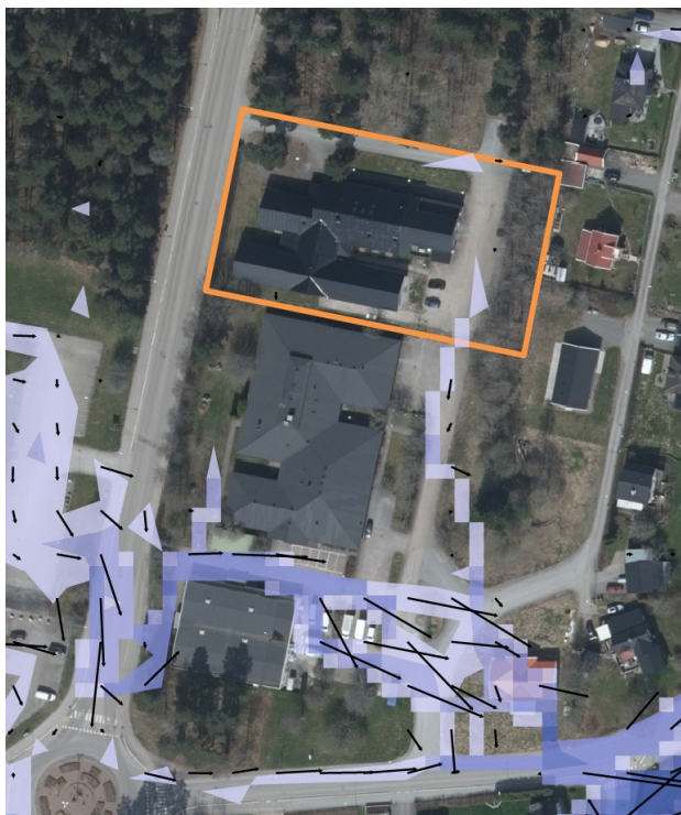
Figur 2 Visar vattenflöde vid skyfall och flödesriktning
