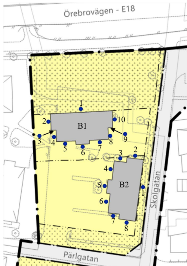
Beräkningpunkter på Varfågeln 1, byggnad 1 (B1) och byggnad 2 (B2)
