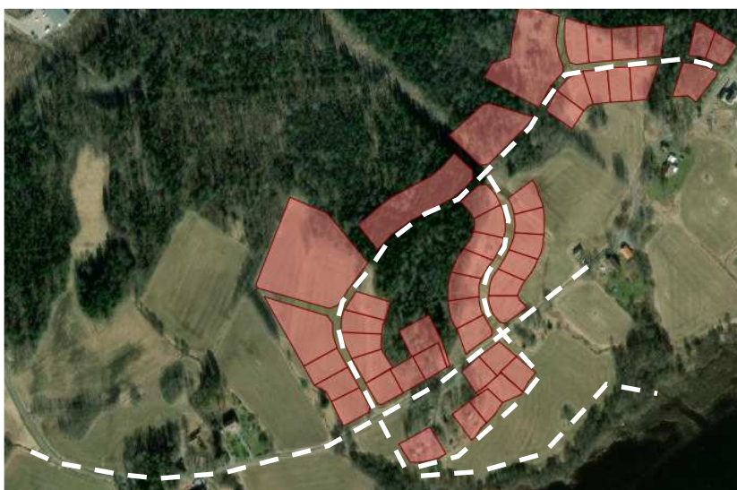
Figur 2 De röda markeringarna visar de planerade fastigheterna. De vitstreckade linjerna visar var VA-ledningar är planerade. Norr är uppåt i figuren.
