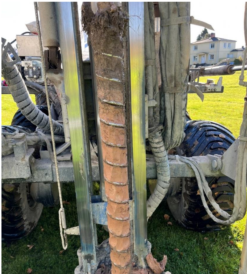
Figur 7-1 Exempel på jordlagerföljd vid skruvborrprovtagning
