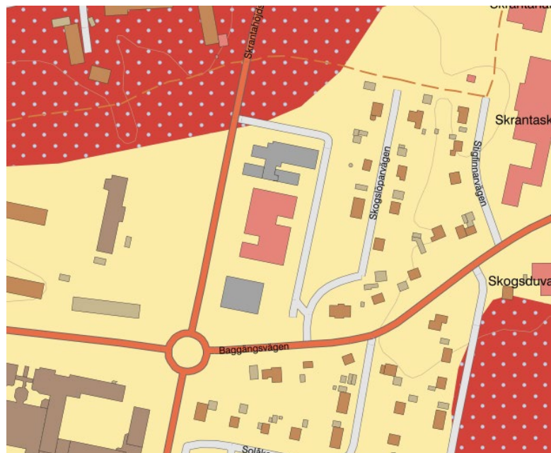
Figur 5. Kartutdrag från SGU:s jordartskarta över aktuellt område – jordarter inom området är lera-silt (gulfärgat område) och morän/berg (prickat rött område) (SGU 2024).
