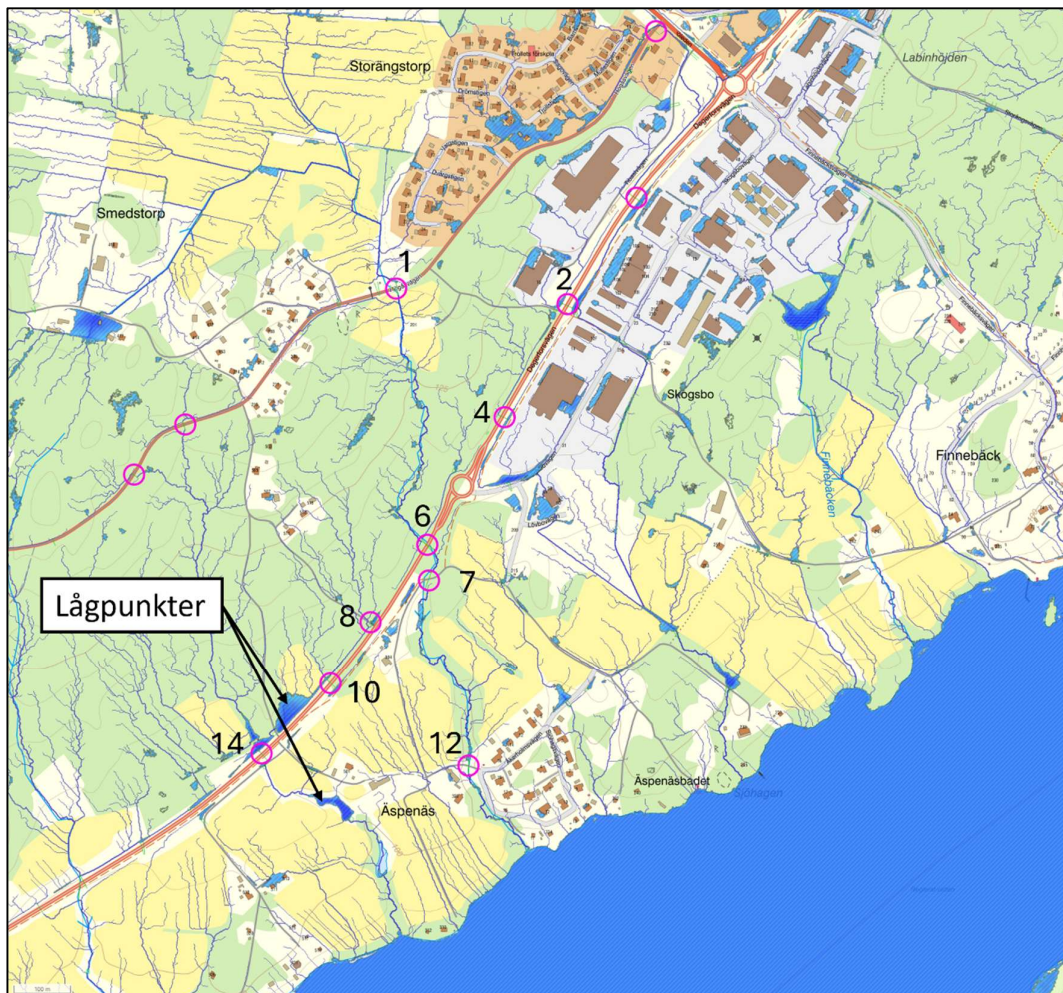
Figur 8. Rinnvägar och lågpunkter vid skyfall enligt Scalgo Live. Trummor som tagits med i analysen är markerade med rosa ring samt numrerade enligt inventerade trummor från platsbesök.
