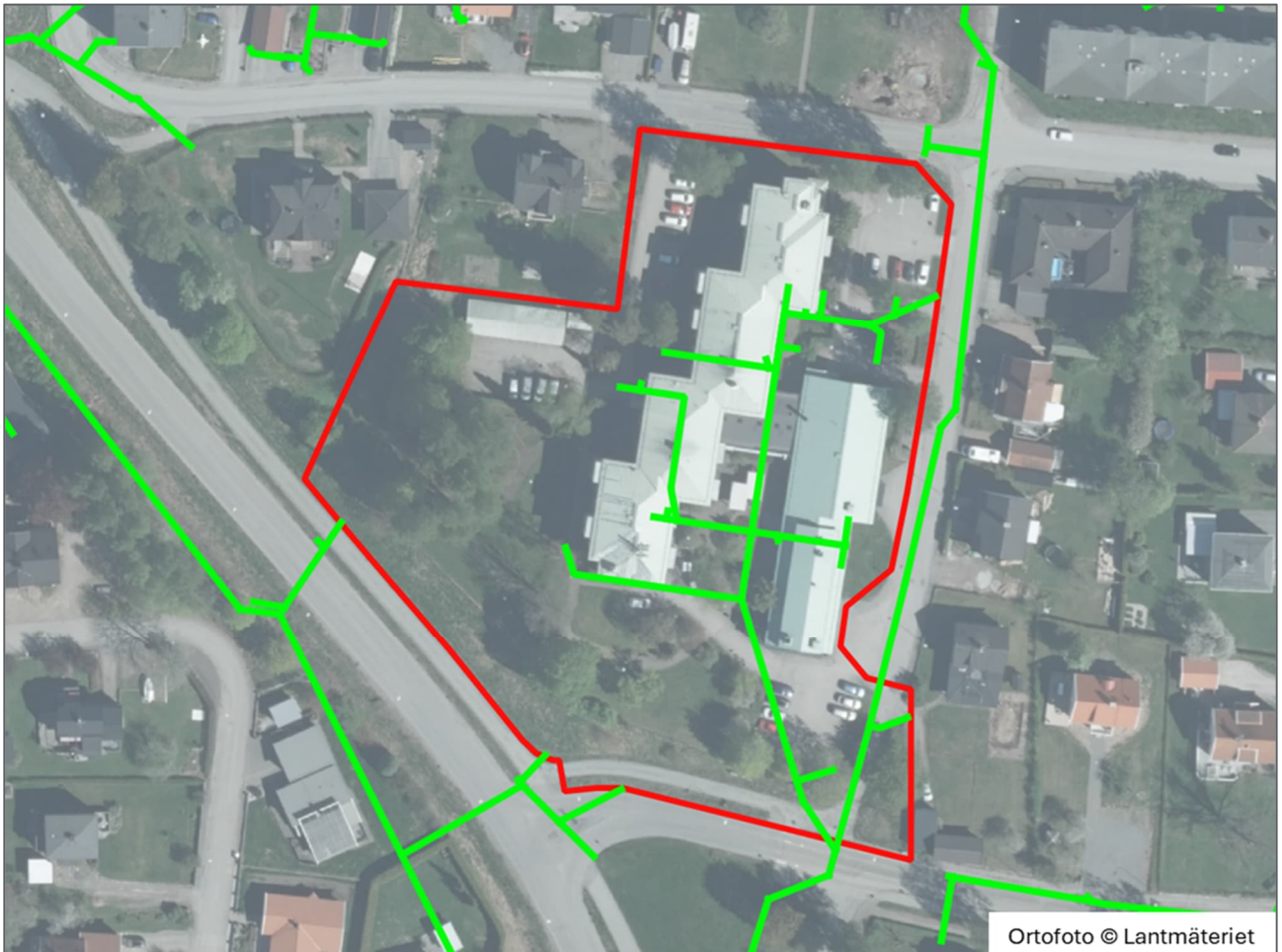
Figur 9. Dagvattensystem (grön linje) inom planområdet, underlag mottaget från Karlskoga kommun 2024-10-15.
