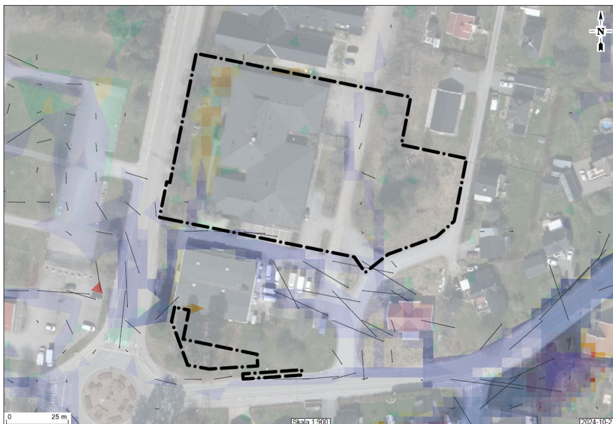
Figur 6. Kartbilden visar flöden, flödesriktning och djuppunkter för dagvatten vid ett 100-årsregn.
