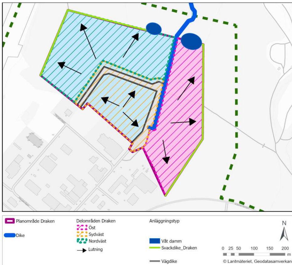
Figur 19. Föreslagen systemlösning inom planområdet Draken. Dammarna är skalenliga, diken är ej skalenliga. Bakgrund © Lantmäteriet, Geodatasamverkan.
