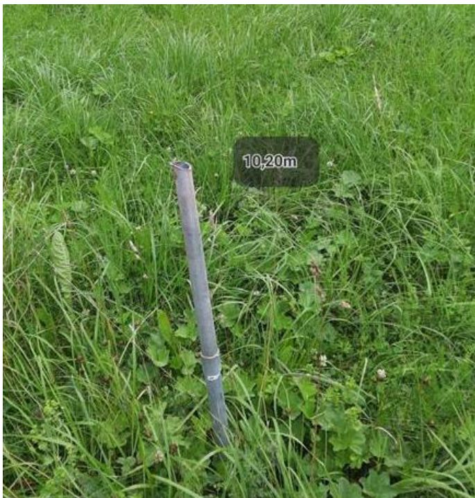
Figur 6 Bilden visar grundvattenrör 25SW09G som har blivit skadat. Foto taget av Karlskoga kommun 5/8 2025.
